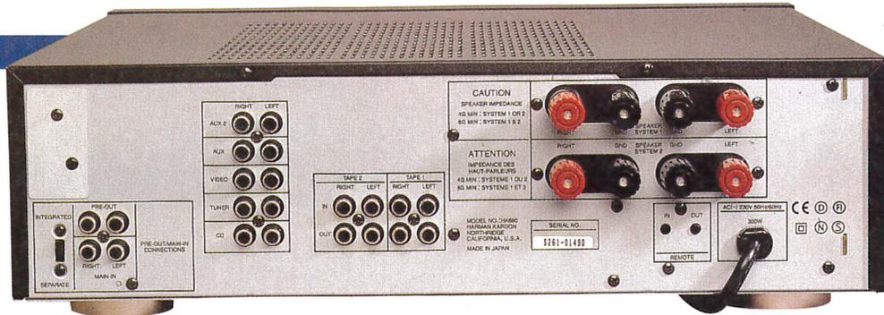
*Il pannello posteriore comprende una nutrita serie di ingressi, e le prese destinate alla separazione tra preamplificatore e finali, asseviate ad un interruttore.*
